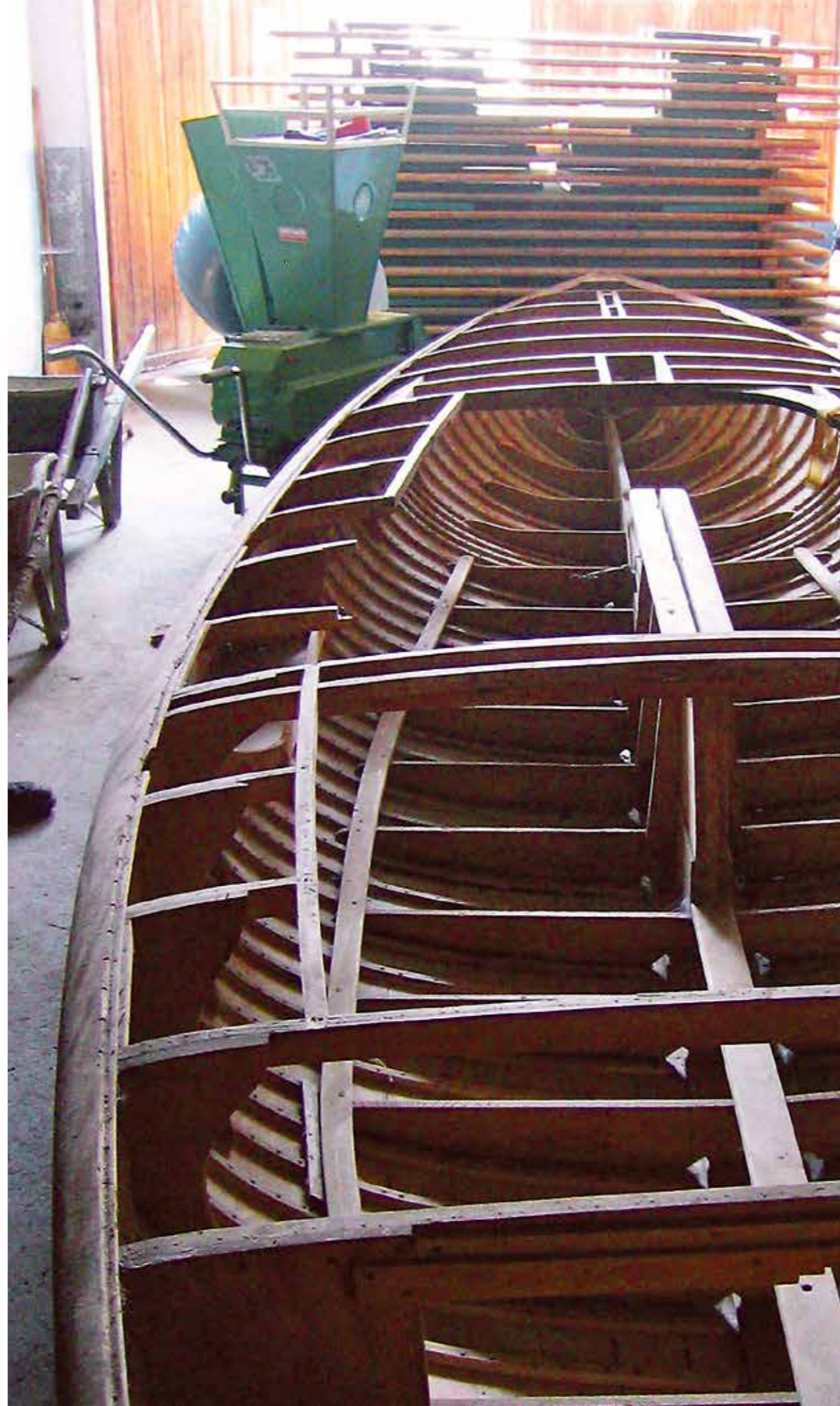
In Tausenden von Arbeitsstunden wird ein altes Holzboot wieder fahrtüchtig gemacht (im Bild: eine H-Jolle vor der Restauration).
